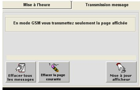
Dans le mode GSM/DATA, voici la zone du logiciel permettant la programmation des messages, la mise à l'heure de l'horloge temps réel, l'effacement d'un message et de tous les messages de la mémoire de messages.
