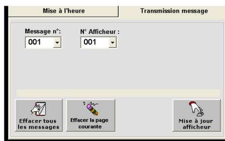
Dans les modes RS232/485, modem RTC et TCP/IP, voici la zone du logiciel permettant la programmation des messages, la mise à l'heure de l'horloge temps réel, l'effacement d'un message et de tous les messages de la mémoire de messages.
