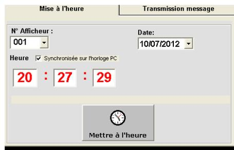
Onglet de mise à l'heure de l'horloge temps réel dans les modes RS232/485, Modem RTC et TCP/IP
