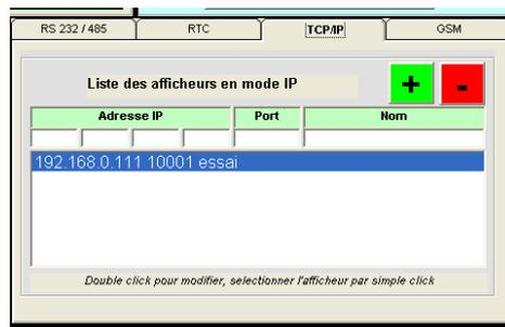
Cette fonction est destinée à programmer l'afficheur via le réseau Ethernet filaire LAN ou WLAN (WIFI). Le module MATCHPORT embarqué comporte les deux fonctions (une à la fois).
