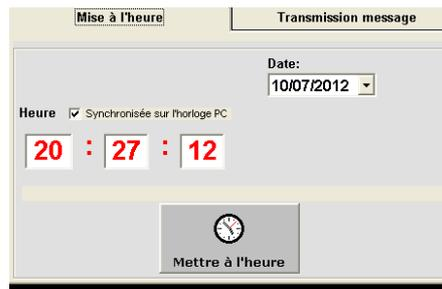
Onglet de mise à l'heure de l'horloge temps réel dans le mode GSM/DATA.
